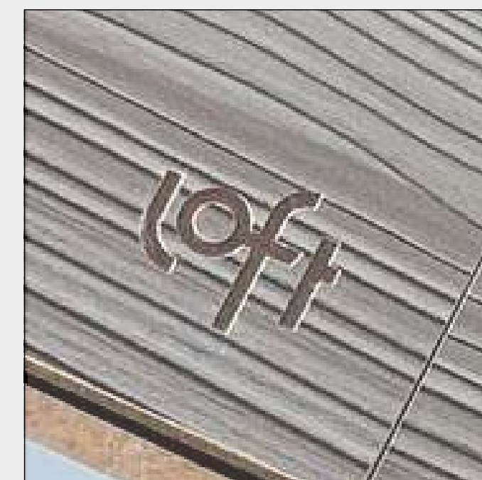
gravação da logo em laser na tampa da caixa de madeira
